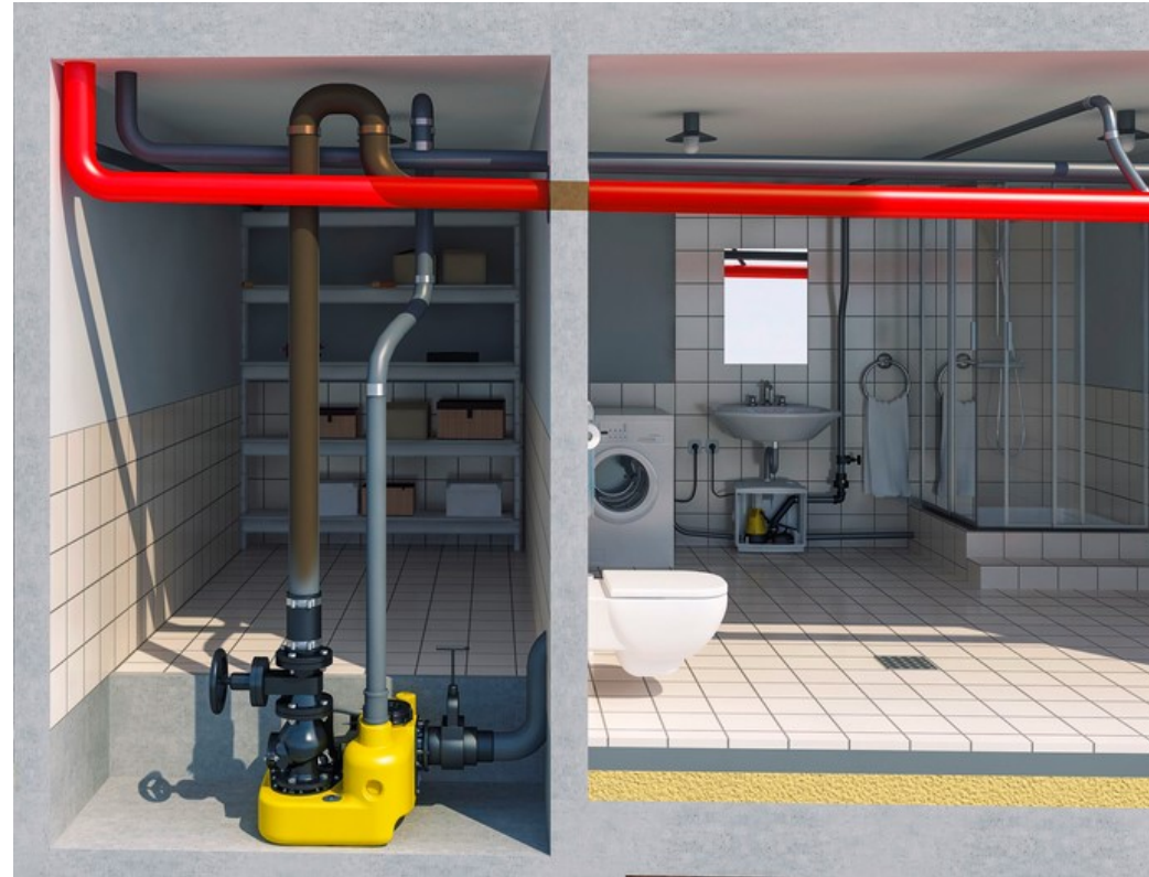
Fäkalienhebeanlage für Schwarzwasser (links) Hebeanlage für Grauwasser (rechts unter Waschbecken) Quelle: Pentair Jung Pumpen
