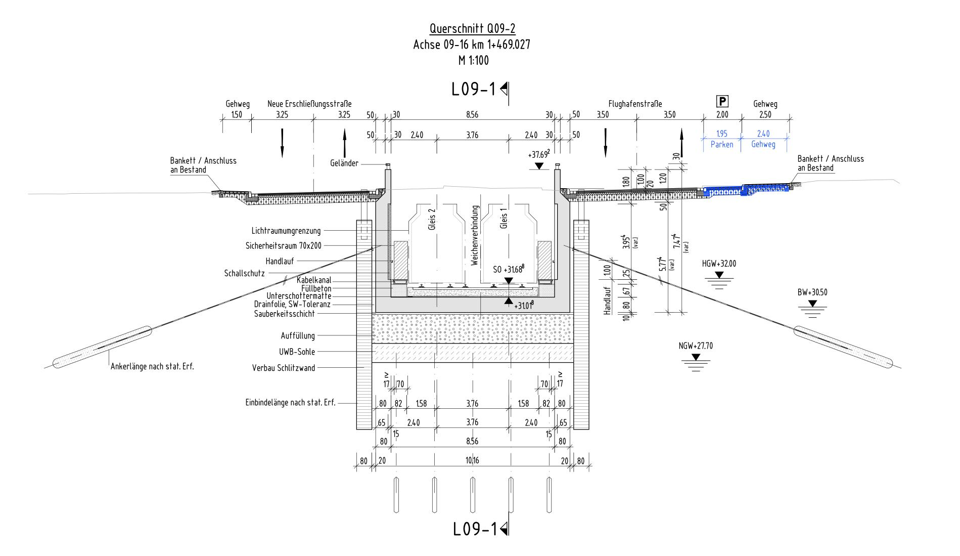
Die von der Trassierung und dem Fahrzeuglichtraum abhängigen Bauwerkslichtraumabmessungen sind für die Ausführung gem. der geometrischen Bauwerkslichtraumeinrechnung zu ermitteln
