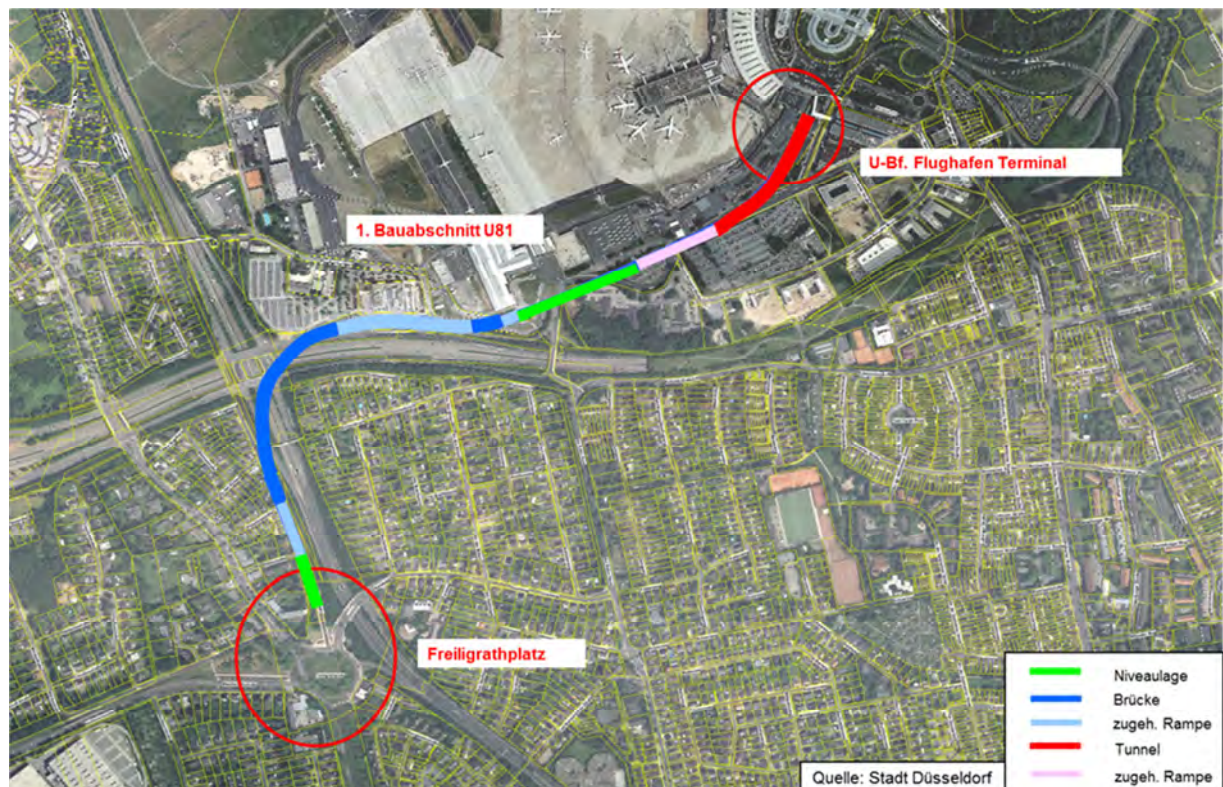
Abbildung 1: Übersichtslageplan U81 / 1. Bauabschnitt
