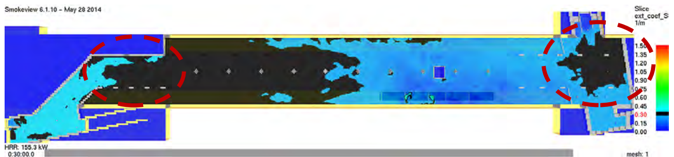
Abbildung 81: Schnittbild Extinktionskoeffizient – Verteilerebene im Süden Horizontalschnitt z = 6,0 \text{ m} – Grenzwert: \text{Ext}=0,3 \text{ m}^{-1}
