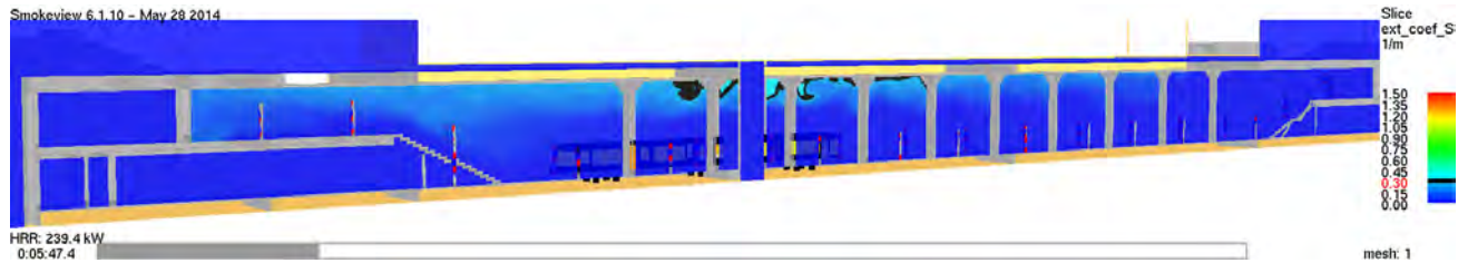
Abbildung 48: Schnittbild Extinktionskoeffizient – Vertikalschnitt y = 9,5 \text{ m} – Grenzwert: \text{Ext}=0,3 \text{ m}^{-1}
