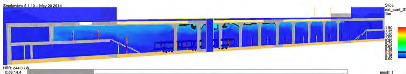
Abbildung 55: Schnittbild Extinktionskoeffizient – Vertikalschnitt y = 9,5 m – Grenzwert: Ext=0,3 m -1
