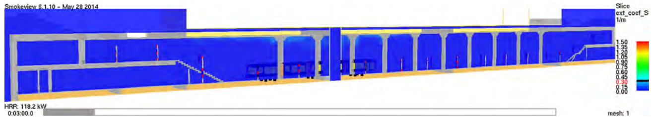
Abbildung 34: Schnittbild Extinktionskoeffizient – Vertikalschnitt y = 9,5 \text{ m} – Grenzwert: \text{Ext}=0,3 \text{ m}^{-1}
