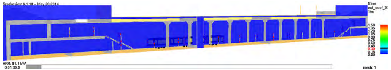
Abbildung 29: Schnittbild Extinktionskoeffizient – Vertikalschnitt y = 9,5 \text{ m} – Grenzwert: \text{Ext}=0,3 \text{ m}^{-1}
