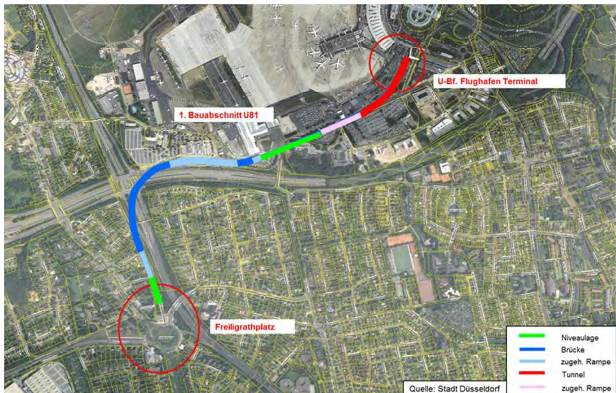
Abbildung 1: Übersichtslageplan U81 / 1. Bauabschnitt
