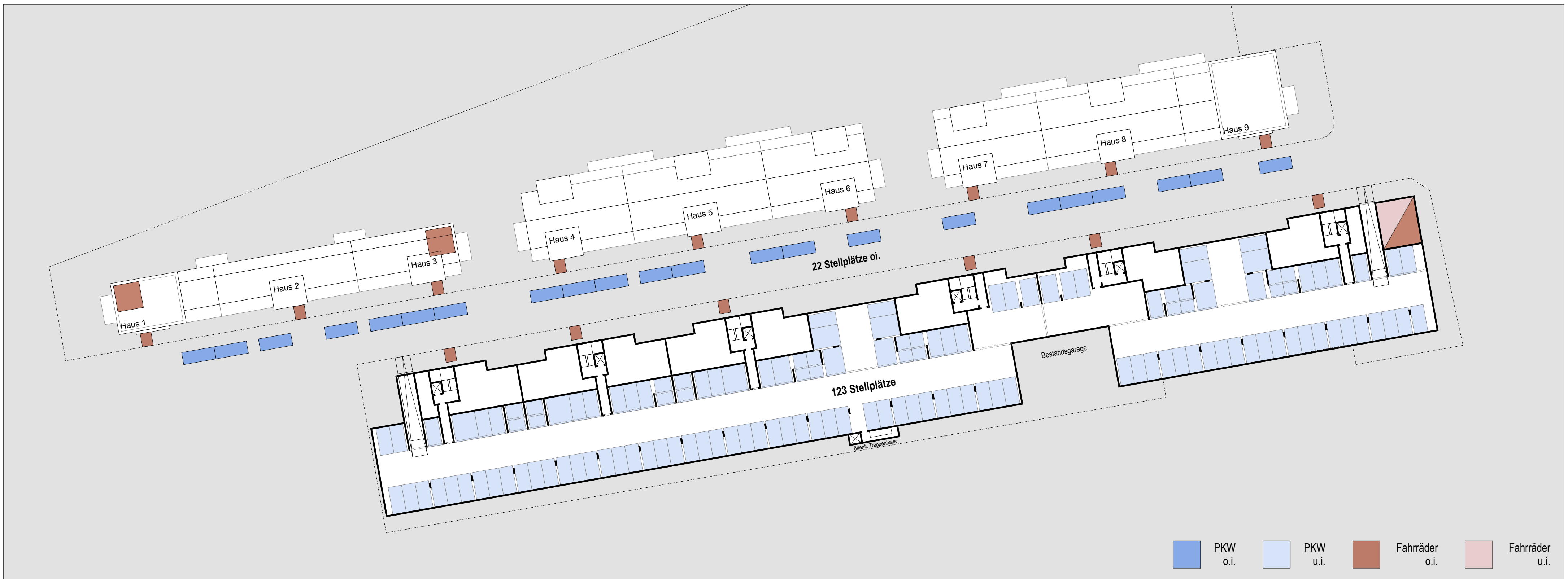
Grundriss Untergeschoss + Stellplatzkonzept M 1:500
