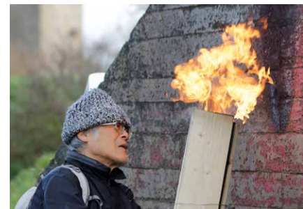
Terunobu Fujimori, Karbonisierung von Hölzern für ein Teehaus auf der Raketenstation Hombroich, Dezember 2019
