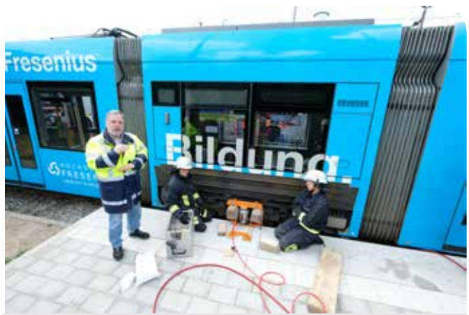
Unterbauung mittels Holzklötzen und Keilen, so dass später die Bahn gleichmäßig aufgebockt werden kann. Foto: Miernik, Jaroslaw
