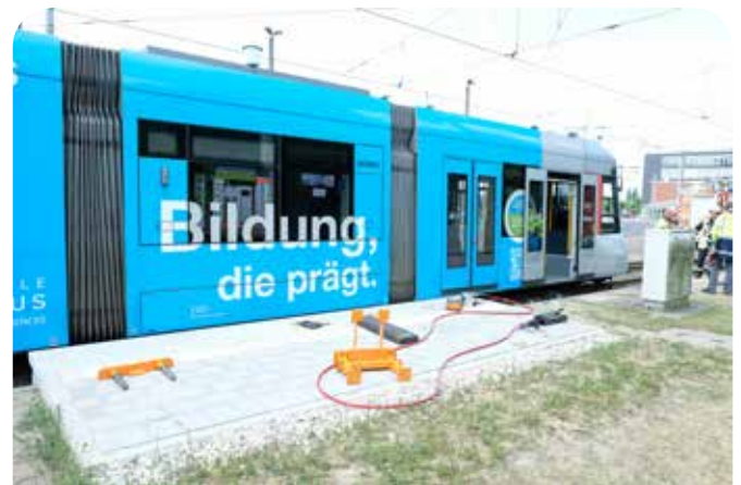
Nachbildung der „Wehrhahnlinien-Bahnsteigkante“ auf dem Lierenfelder Betriebshof. Foto: Miernik, Jaroslaw
