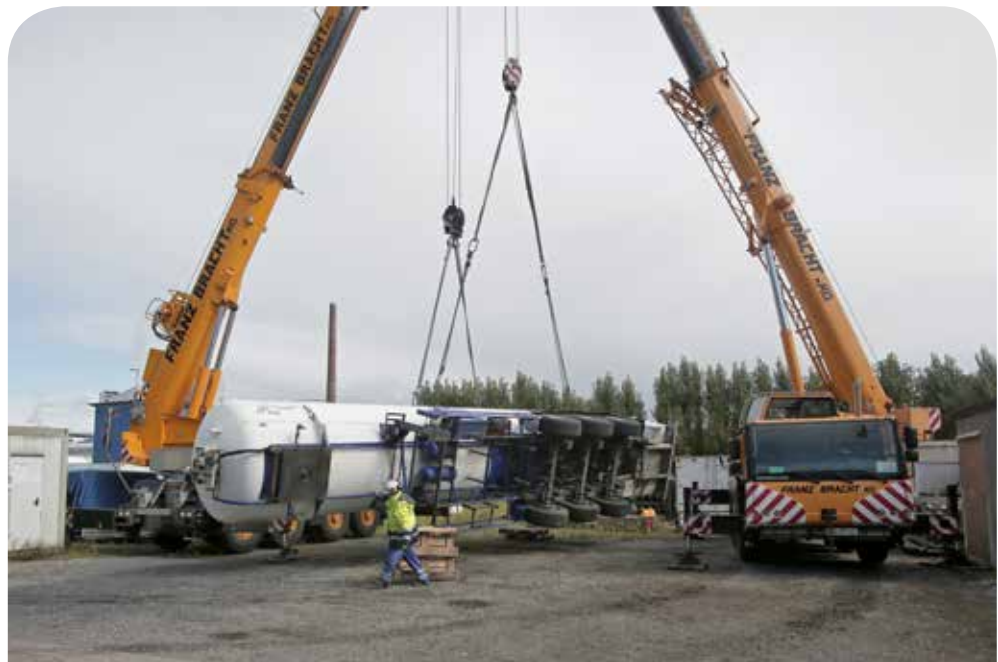
Aufrichten eines Tankaufliegers mit zwei Kranen.
