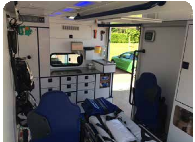
RTW-Innenraum mit Materialschränke
