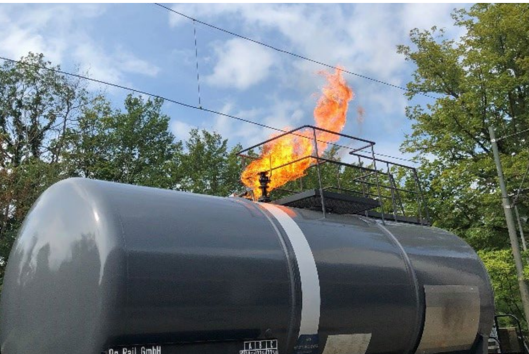
Der Kesselwagen verfügt über zwei Brandsimulationstellen
