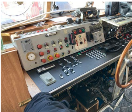
Tausch der alten analogen Anzeige gegen neue digitale Anzeigen im Steuerhaus
