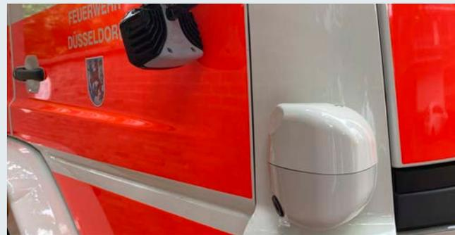
Das System wurde außen an der A-Säule auf der Beifahrerseite montiert und beinhaltet neben einem Radarsensor ebenfalls eine Kamera. Je nach Lenkradeinschlag und Blinkerstellung schaltet sich das System in einem rund zehn Quadratmeter großen Bereich auf der Beifahrerseite automatisch zu und zeigt dem Fahrer das Bild der Kamera in einem Monitor. Bei Gefahr ertönt zusätzlich ein Signalton und es blinkt eine rote LED.
