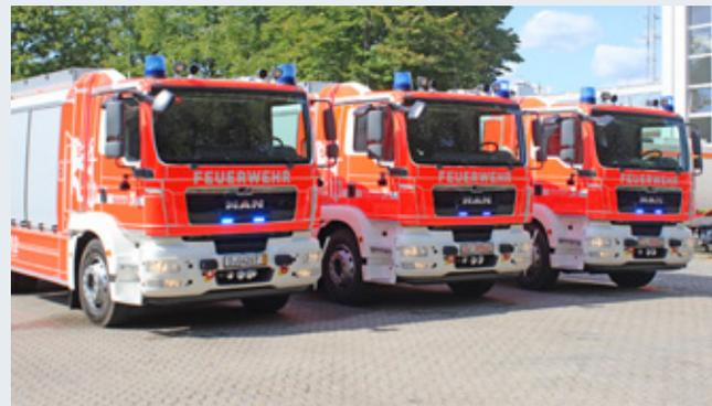
Sie verfügen über einen Tank mit 4.000 Liter Löschwasser, das auch über einen auf dem Dach verbauten Wasserwerfer abgegeben werden kann. Mit an Bord sind ebenso 200 Liter Netzmittel und eine 250 Kilo Pulverlöschanlage. Nach einer Schulung aller Feuerwehrleute, gingen die Fahrzeuge an den Standorten Oberkassel, Flingern und Garath in den Dienst.
