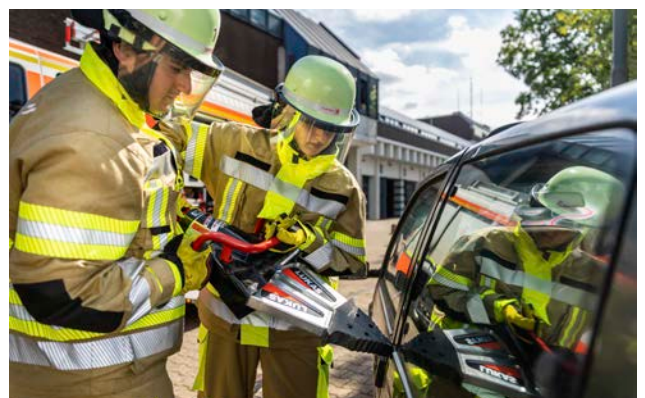
Nachwuchskräfte öffnen mittels hydraulischem Rettungsgerät eine verzogene Fahrzeugtür.
