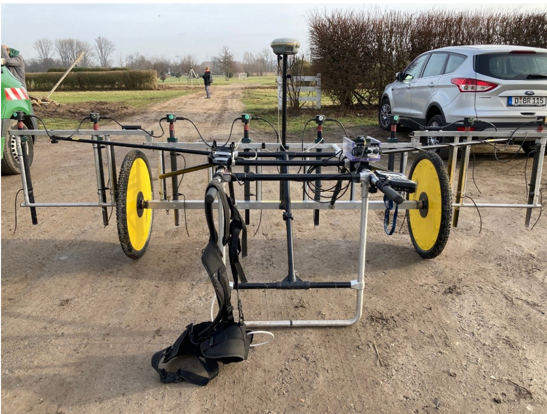
Abbildung 3, Handwagen 8 Sonden, 3,50 Meter breit, Gewicht ca. 60 Kg
