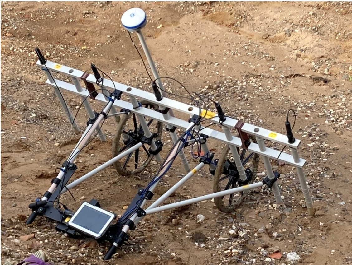
Abbildung 2, Handwagen 5 Sonden, 2,00 Meter breit, Gewicht ca. 30 Kg
