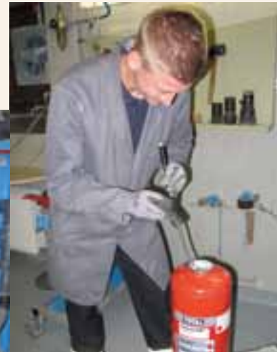
Kontrolle des Behälterinneren
