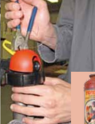
Plombieren der Schlagventileinheit
