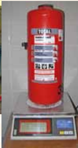
Wiegen des leeren Feuerlöschers
