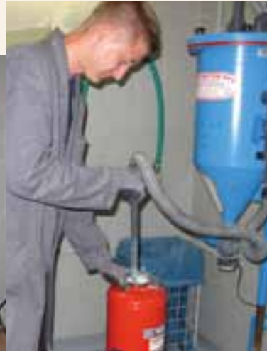
Absaugen des Löschmittels
