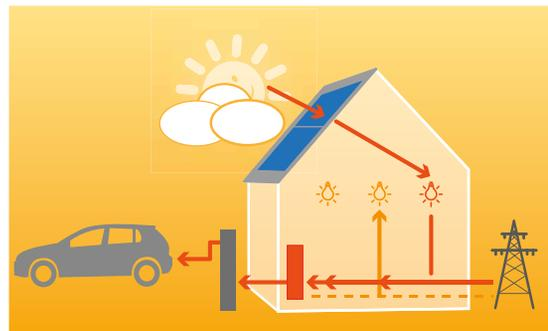
An guten und mittleren Sonnentagen versorgt die Sonne ganz allein Ihre Stromverbraucher im Haushalt – von der Beleuchtung bis zur Waschmaschine und füllt zusätzlich Ihren Energiespeicher und die Autobatterie. Überproduktionen verkaufen Sie ins Stromnetz. An eher bedeckten Tagen können Sie nun aus Ihrer Speicherbatterie – je nach Größe und Verbrauch – noch Tage oder Wochen Ihre Haushaltsgeräte betreiben.
