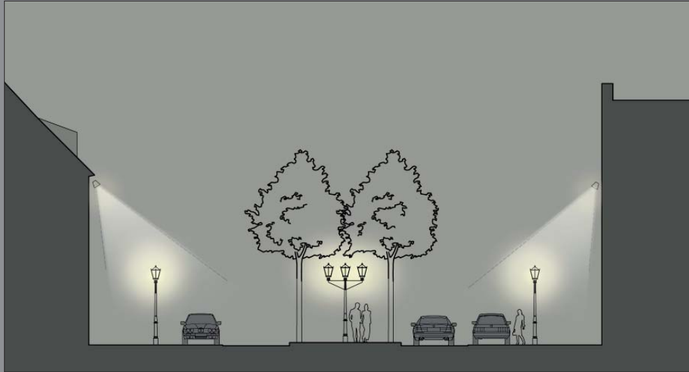
Ergänzung der Beleuchtung durch Traufstrahler
