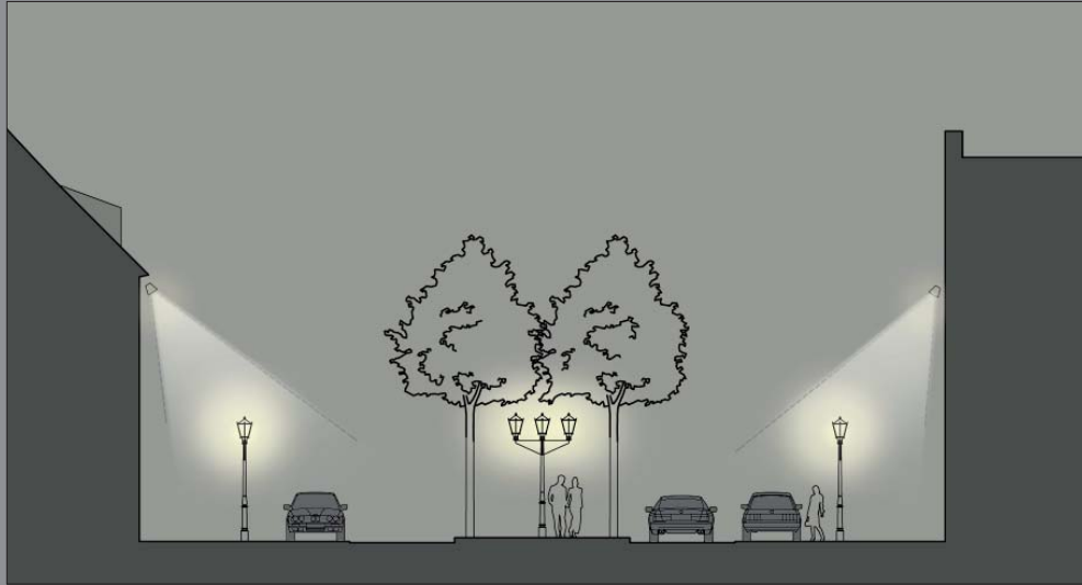
Ergänzung der Beleuchtung durch Traufstrahler
